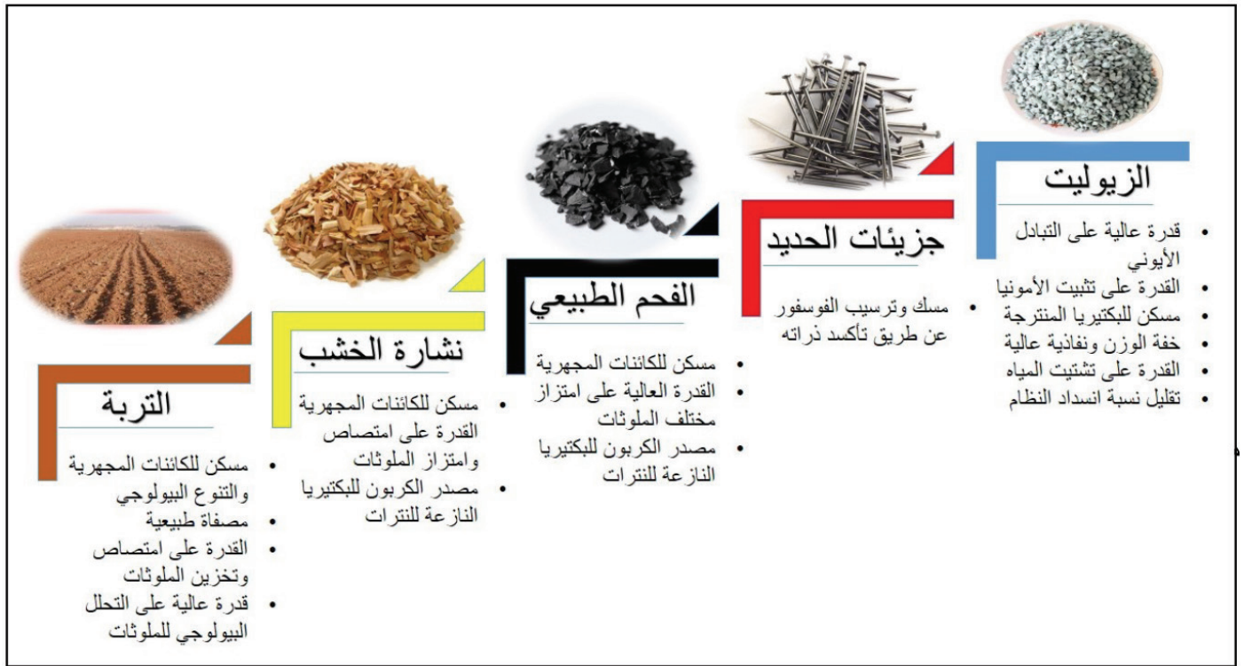
شكل 3. مميزات وأدوار مواد نظام المرشحات المتداخلة.
