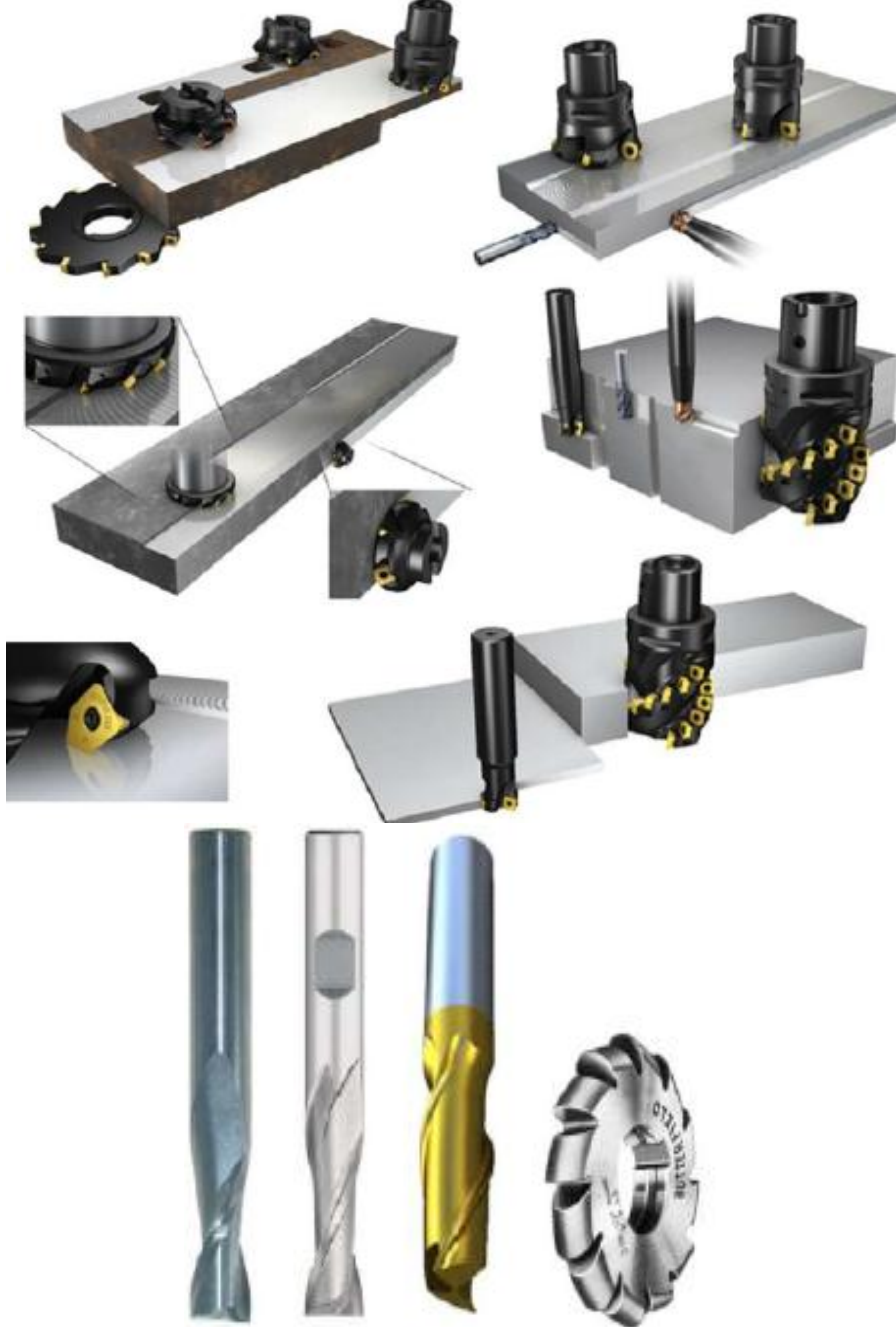
شكل (11-8) سكاكين تفريز مختلفة حسب نوع المعدن
