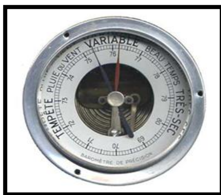
الباروميتر المفرغ Arenoid Barometer
