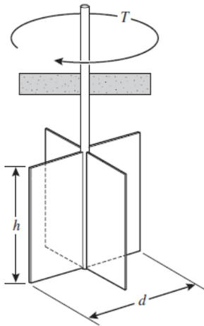
Fig. 2.17 Vane tester
