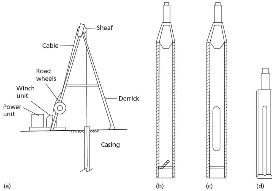
Fig. 2.3 (a) Percussion boring rig, (b) shell, (c) clay cutter, and (d) chisel.
