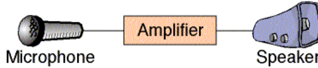
شكل (26): ميكرفون و سماعة يوصل بينهما جهاز تكبير
