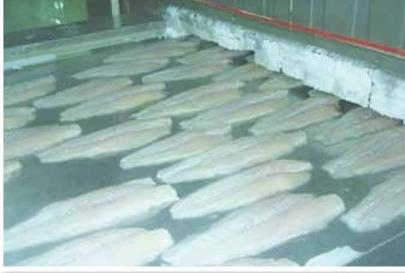
الشكل (٢-١٥): التجميد بالأحزمة المستمرة.
