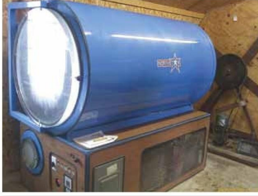
الشكل (٢-١٩): جهاز التجفيد.
