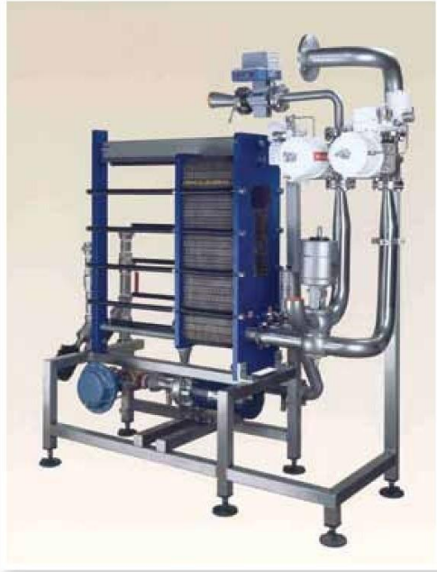
الشكل (١١-٢): جهاز البسترة السريعة ذو الألواح.
