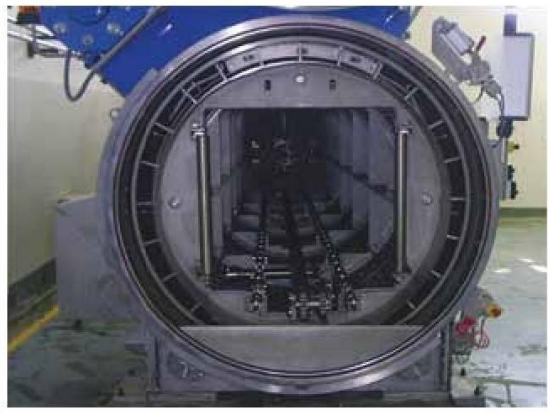
الشكل (٢-١٣): جهاز التعقيم المستمر.
