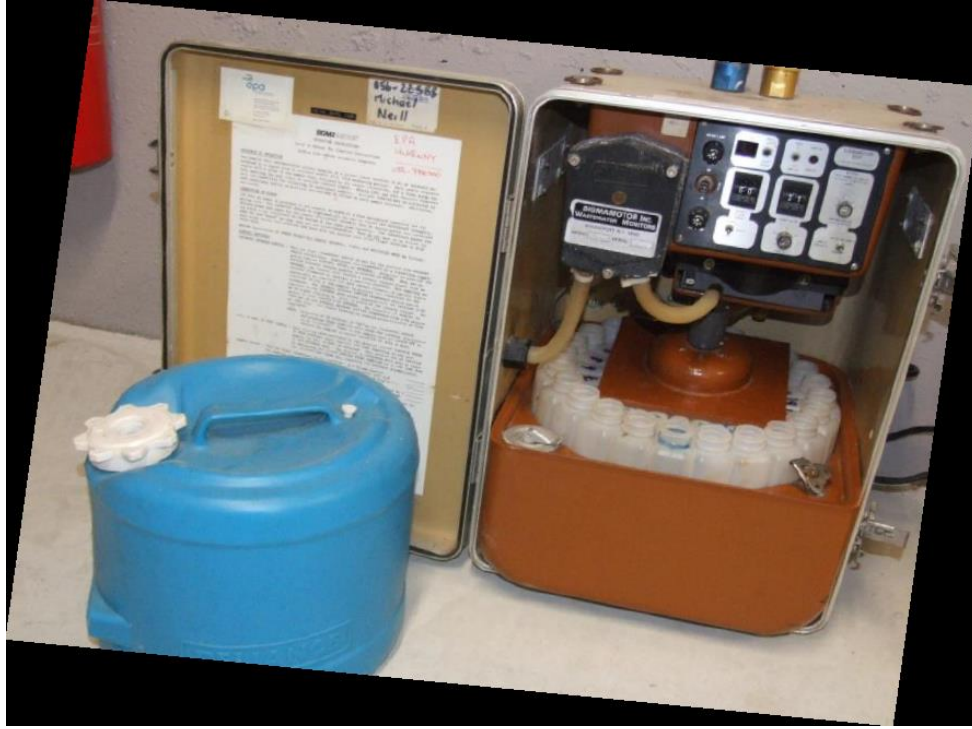
صورة لجهاز يعمل على جمع العينات المائية المركبة (Composite Samples) بشكل اوتوماتيكي
