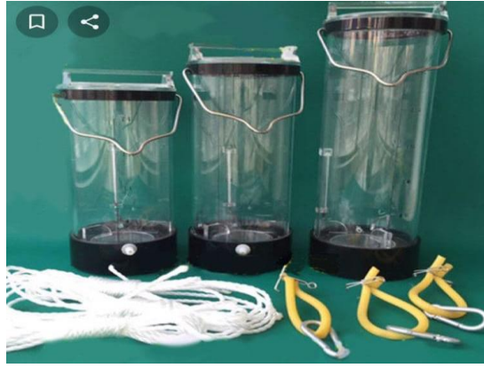
صورة (٥) : جهاز جمع عينات المياه من اعماق مختلفة
