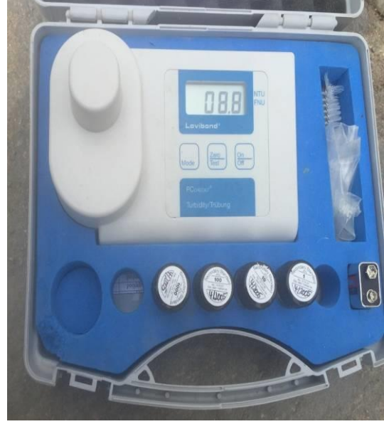
صوره رقم (1-2): جهاز قياس العكورة Turbidity Meter
