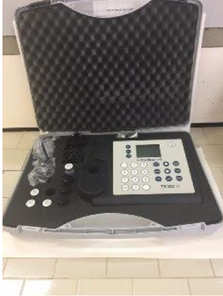
صوره رقم (1-2): جهاز قياس العكورة Turbidity Meter
