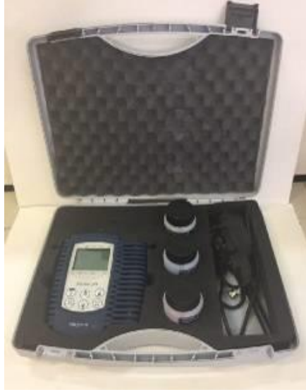
صوره رقم (2-4) جهاز قياس الحامضية pH Meter
