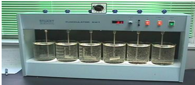
صوره رقم (2-2) جهاز اختبار الكأس (Jar test)
