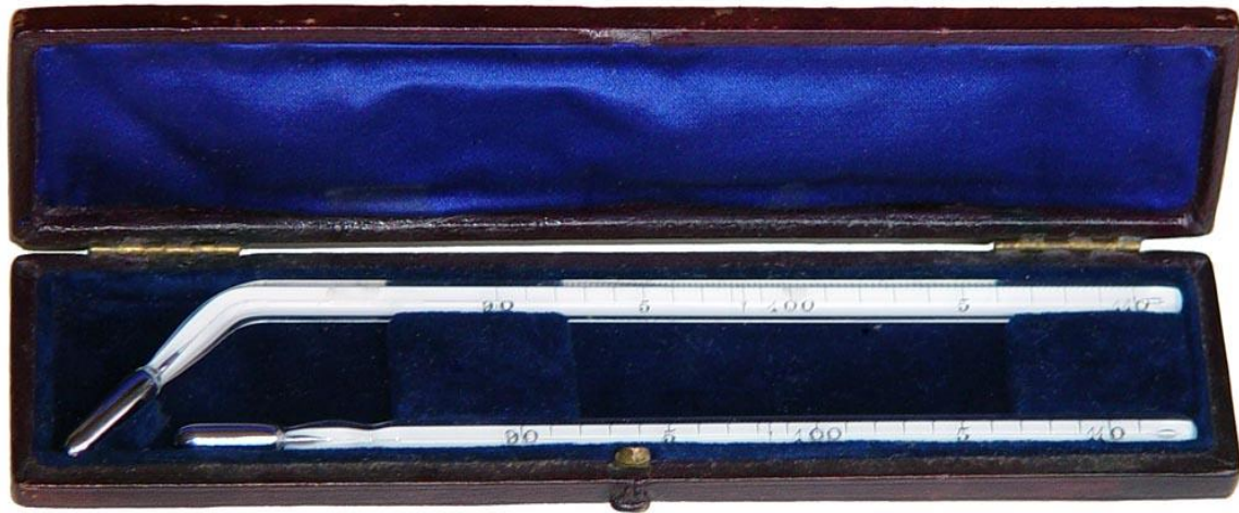
شكل (8) : اشكال محارير التربة العمودية والمائلة
