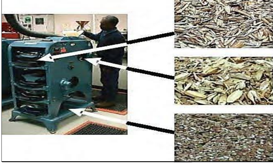
شكل (2) جهاز Cartes -dockage Tester لعزل وتقدير الشوائب في الحبوب
