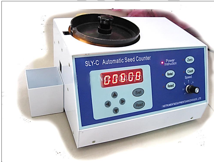
شكل (3) جهاز عد الحبوب الميكانيكي
