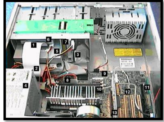
الشكل ٢٤-٢ الأجزاء الداخلية لوحدة النظام، مع منظر علوي وجانبي للوح الأم
