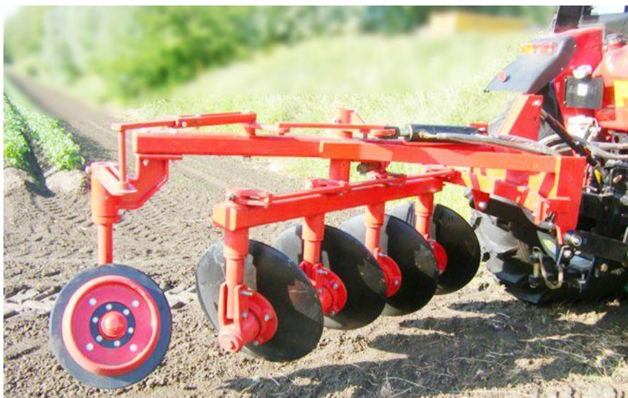
شكل 24: المحراث القرصي القلاب ذو الاتجاهين.
