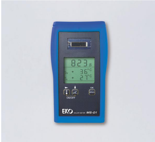
جهاز رقمي لقياس شدة الإشعاع الشمسي
