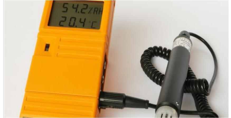
شكل (83ب): جهاز حديث لقياس الرطوبة
