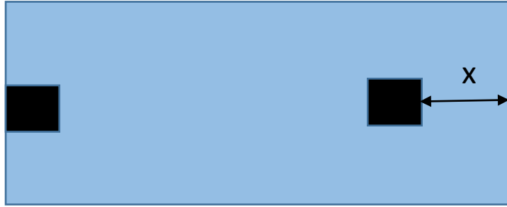
أساس متصل بشكل مستطيل غير متناظر مع عمود ملاصق لحدود قطعة مجاورة
