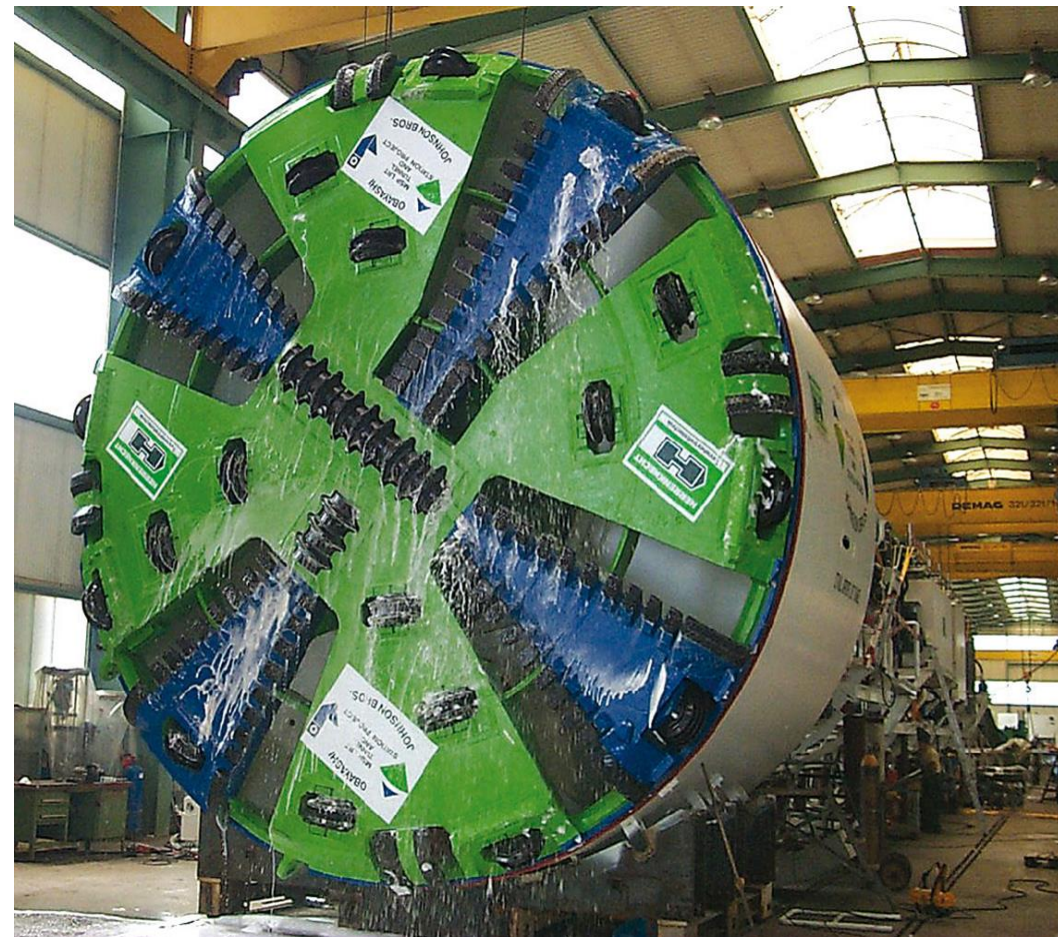
حفارة الأنفاق ( Tunnel Boring )
