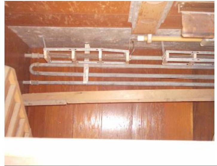
شكل رقم ( ٢٥ ) مصدر الحرارة داخل المفرخة
