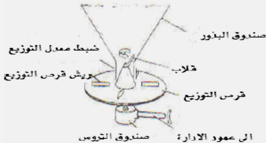
شكل (4_65) الأجزاء الأساسية لآلة نثر البذور
