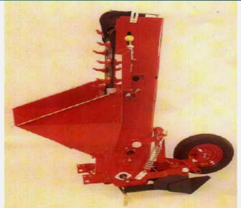
شكل (4.85) آلة زراعة بطاطس أوتوماتيكية ذات سير رأسي
