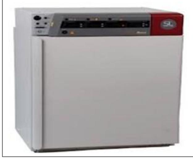
4- الحاضنة الهزازة: وهو جهاز يستخدم لحضن المزارع المايكروبية في الاوساط السائلة لتوفير الظروف المناسبة لنمو البكتريا وغيرها من الاحياء المجهرية التي يزداد نموها بتوفير الحركة والتهوية والحرارة المناسبة للنمو .
