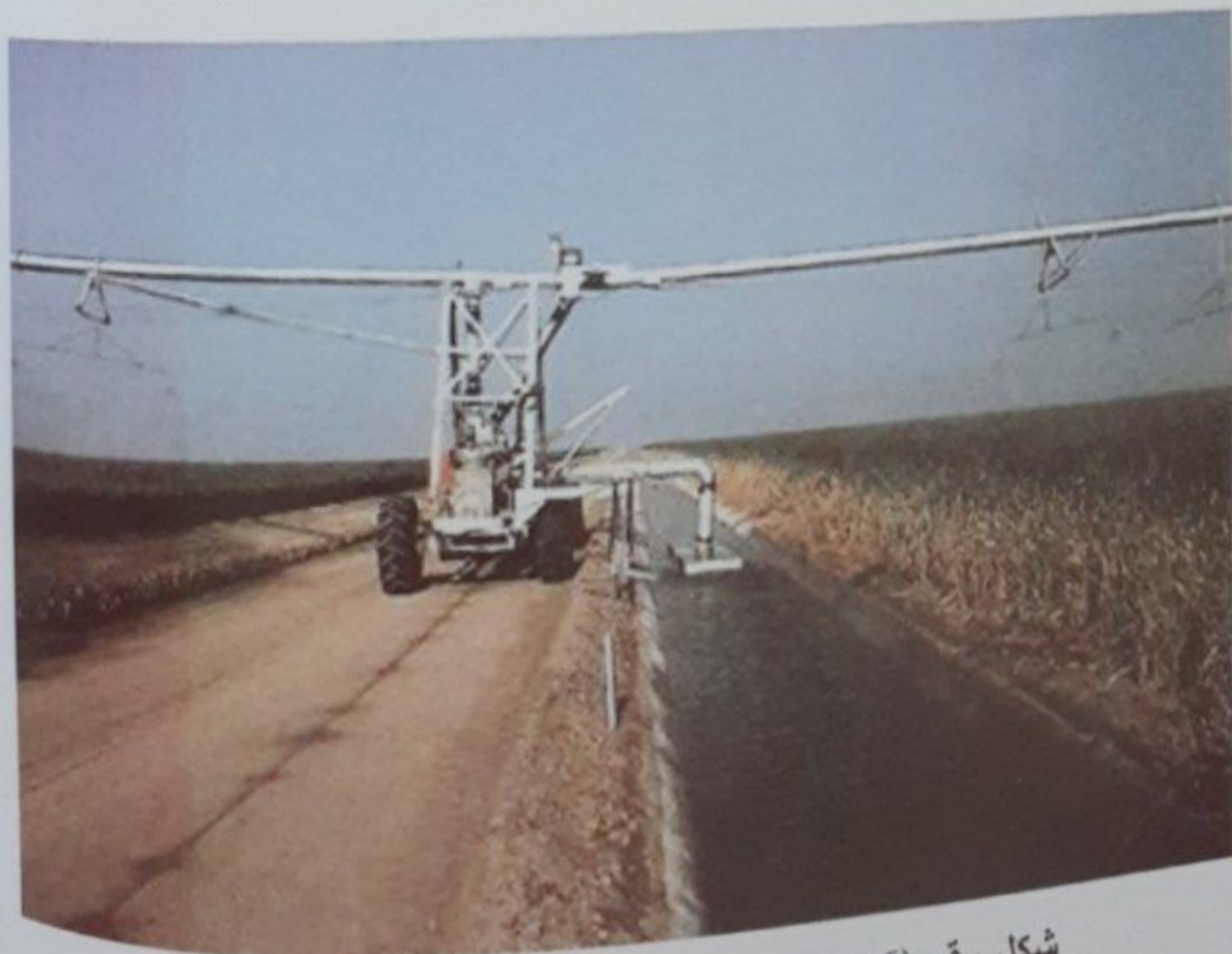
شكل رقم (5-6) نظام الري المحوري مع ذراع ثابت لري الزوايا
