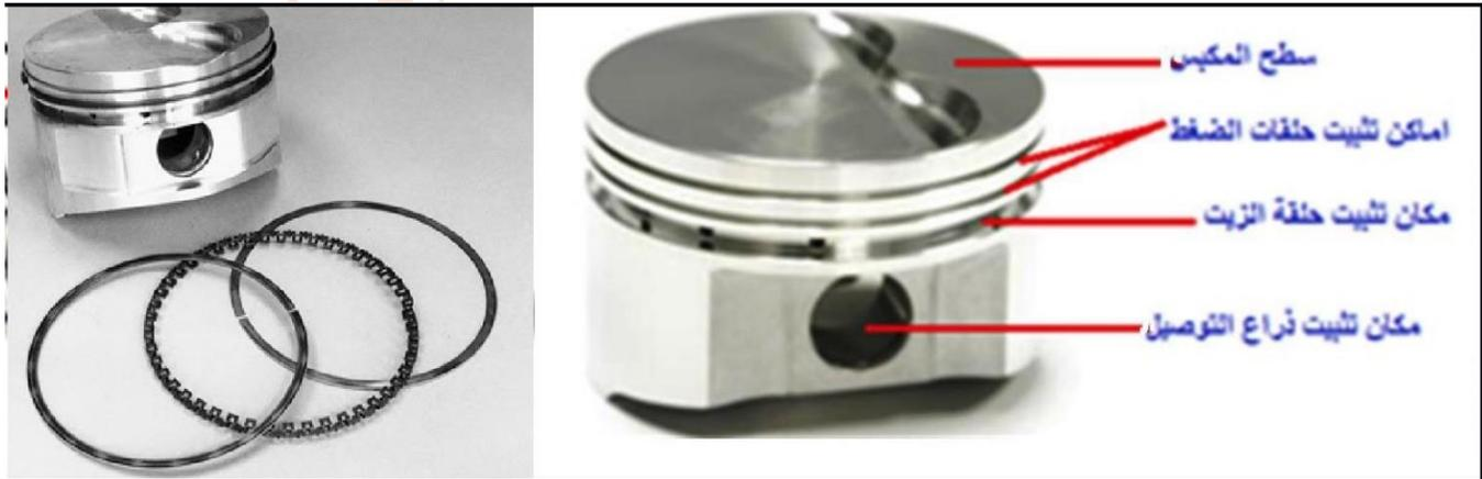
الشكل 5: المكبس وحلقات المكبس
