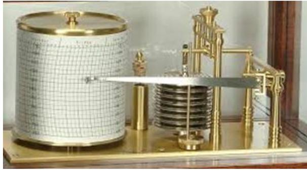
شكل (٧) المحرار المسجل Thermograph
