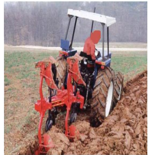
استخدام المحراث القلاب المطرحي في قلب التربة
