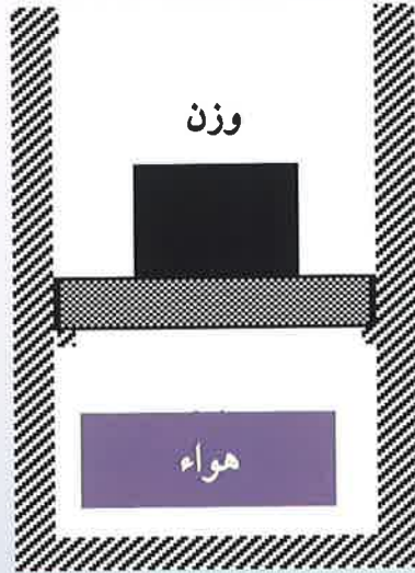
شكل 3-16 اسطوانة غاز بمكبس عديم الاحتكاك
