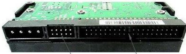
IDE Hard Disk IDE Power Connector IDE Data Connector
