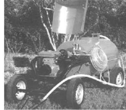
شكل ٥-٣٩: منظر عام ورسم تخطيطي يبين الاجزاء الرئيسية لرشاشة هيدروليكية مزودة بتقليب
