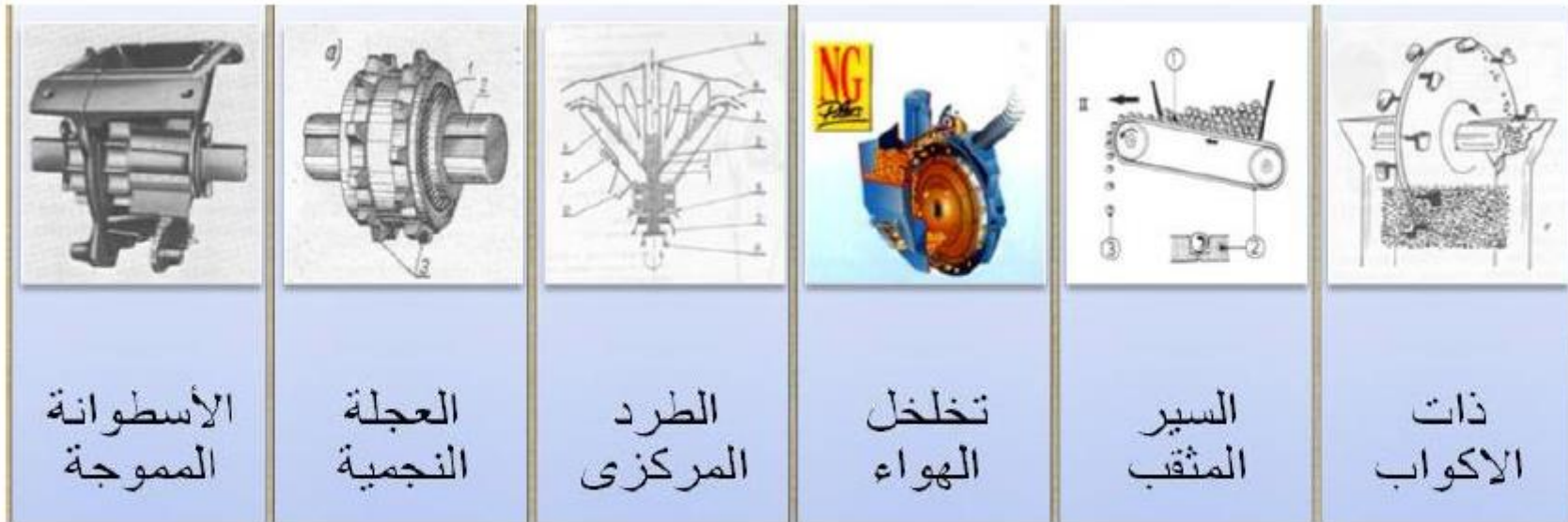
شكل 33: آليات التغذية في آلة تسطير الحبوب.
