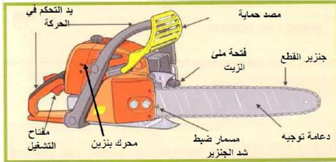
شكل (١٣٠): أحد أنواع المناشير المستخدمة في التقليم والقطع لأفرع الأشجار
