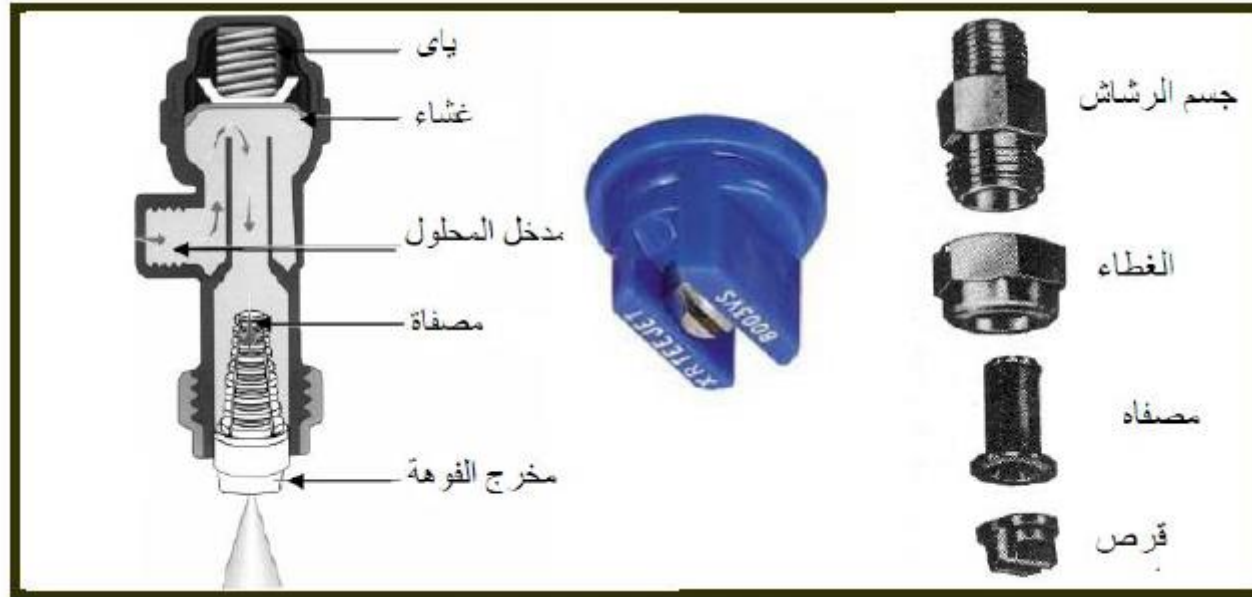
شكل (٦٢): أجزاء بشابير الرش
