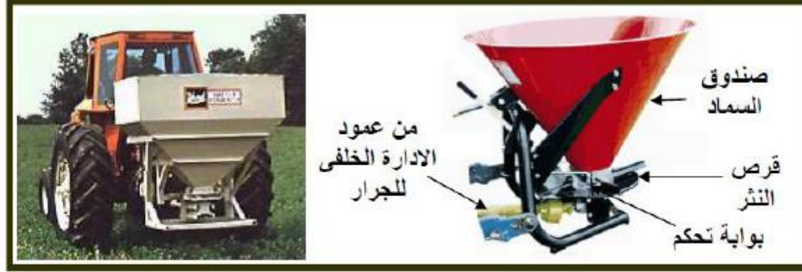
شكل (٥٢): آلات نثر السماد الكيماوى المعلقة خلف الجرار
