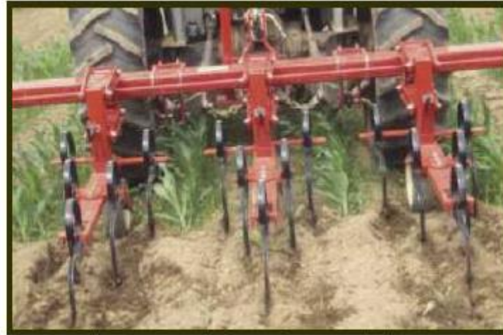
شكل (٤٦): عزاقة ذات اسلحة زنبركية حفارة معلقة خلف الجرار
