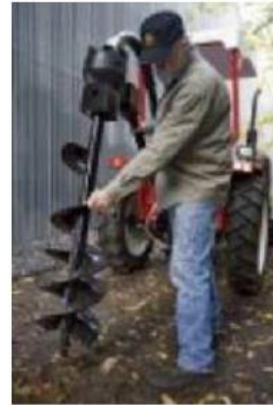
شكل ( ٧٧ ) : آلة حفر الجور توجه باليد وتدفع بالجهاز الهيدروليكي وتدار بمحرك خاص بها
