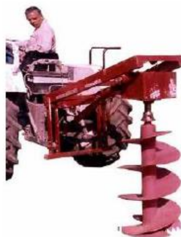
شكل ( ٧٩ ) : آلة حفر الجور تدفع بالجهاز الهيدروليكي وتدار بعمود الإدارة الخلفي
