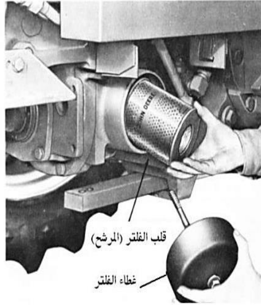
شكل (٢) فلتر متكامل للزيت الهيدروليكي
