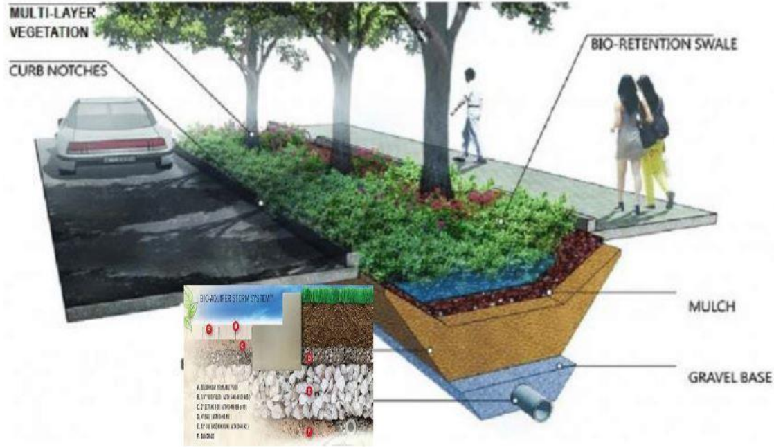
شكل 17 يوضح طبقات الارصفة النفاذة للماء (اسماعيل، 2021)
