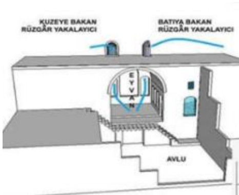
Şekil 23. (sol). Geleneksel konutta rüzgâr kapanlarının yarattığı hava akışı, Urfa (Melikoğlu,Bekleyen, 2021) (sağ). Yeni yapıda merdiven boşluğunun yarattığı doğal havalandırma (M. Guzowski,2019)
