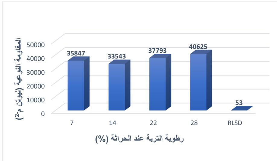
الشكل (62) تأثير رطوبة التربة في المقاومة النوعية (نيوتن م<sup>-2</sup>)
