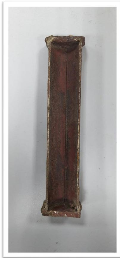
ملحق (6) جهاز mold لقياس حد التقلص
