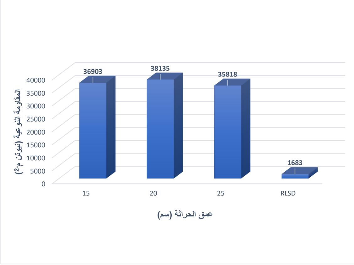
شكل (64) تأثير عمق الحراثة في المقاومة النوعية (نيوتن م-2)
