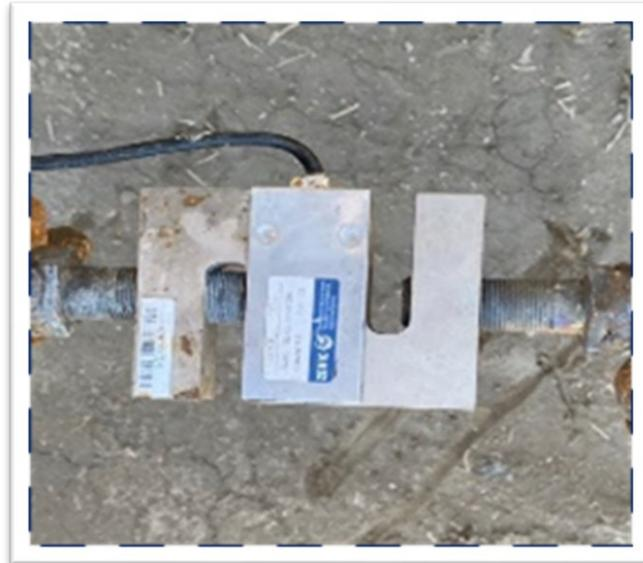
ملحق (8) جهاز قياس قوة السحب
