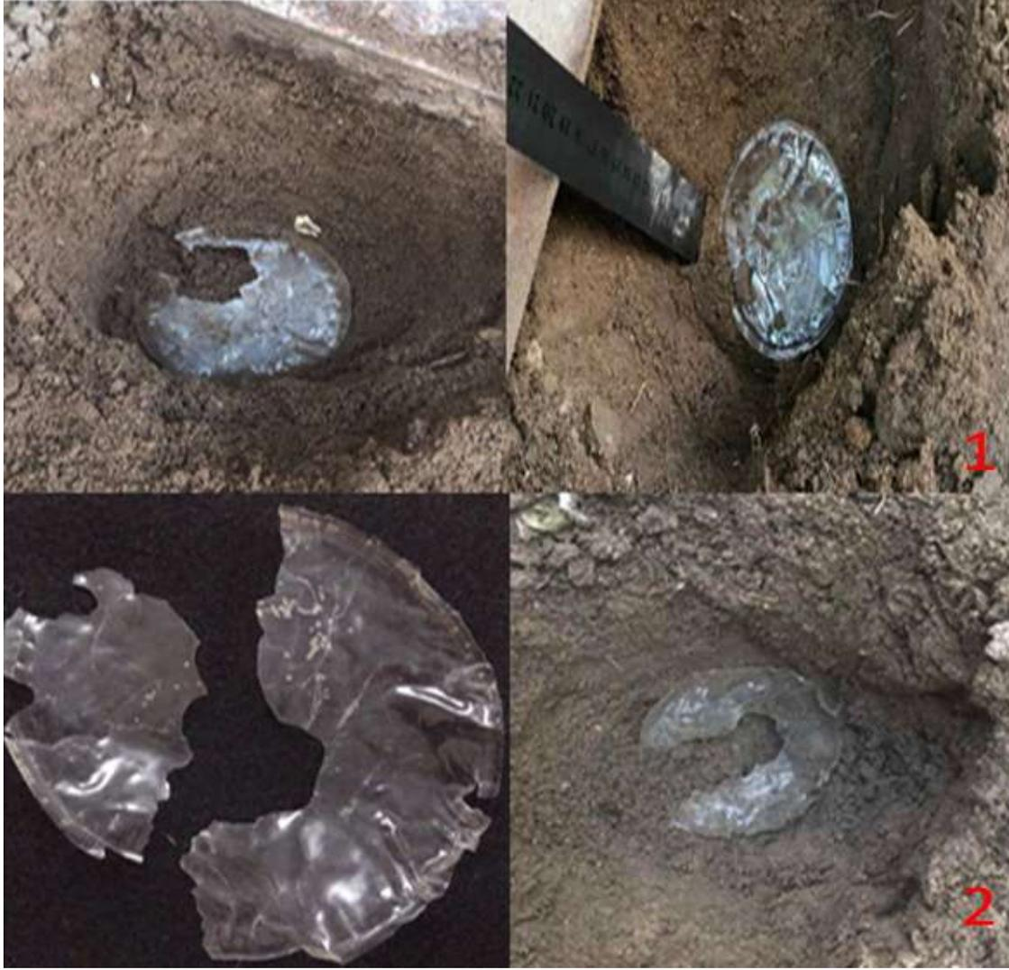
شكل(4-22b): التحلل الحيوي 1- لغشاء PLA 2- غشاء Si NPs 3% + PLA في التربة
