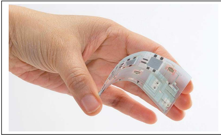
الشكل (4-1) توضح RFID إحدى تطبيقات الإلكترونيات العضوية المرنة. [48]
