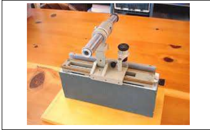
الشكل (8-3) المجهر المستخدم لقياس أبعاد الأقطاب المرسبة.
