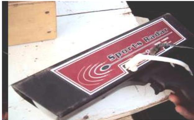
الشكل (1) يوضح جهاز قياس سرعة الكرة (Sports Radar)
