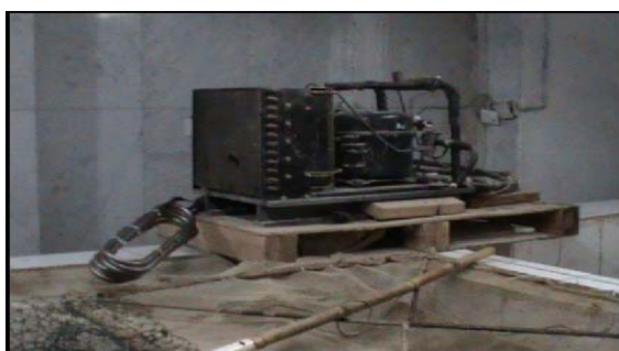
شكل (1) جهاز تبريد الماء الأوتوماتيكي مع ذراع التبريد
