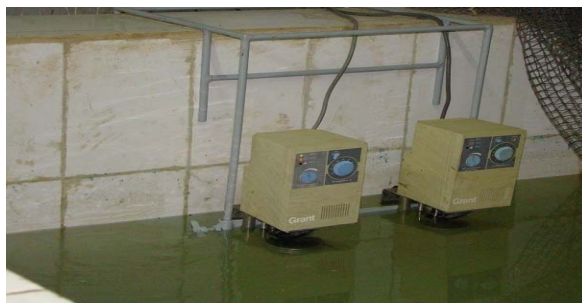
شكل (2) جهاز تسخين الماء الأوتوماتيكي لأحواض التكاثر
