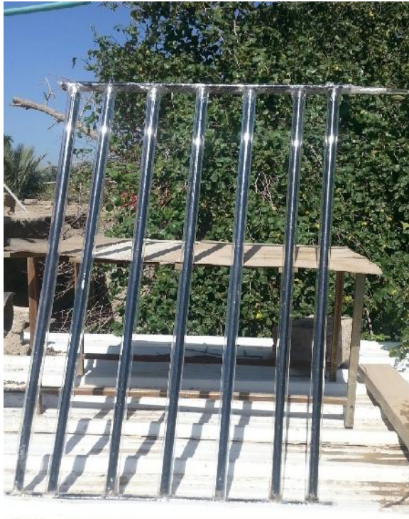
الشكل (2) صورة فوتوغرافية توضح السخان الشمسي مع الأنابيب الزجاجية (فلوريسنت)
