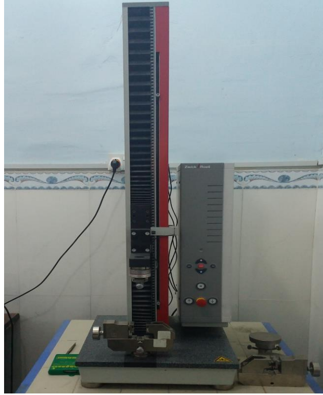
الشكل رقم (3) صورة فوتوغرافية تبين جهاز قياس بعض الخواص الميكانيكية (Tensile).
