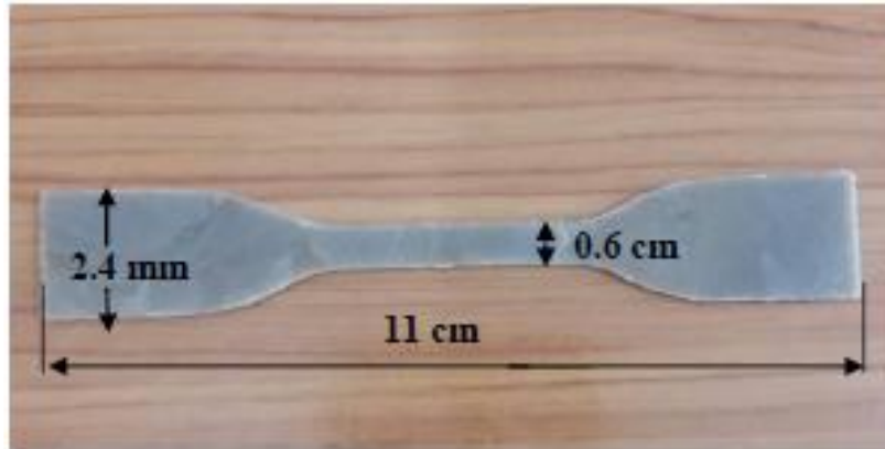
الشكل رقم (2) صورة فوتوغرافية تبين قياسات نموذج فحص مقاومة الشد.
