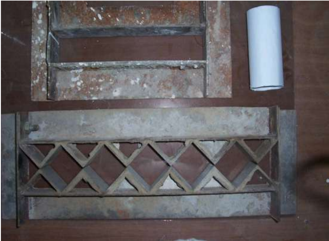
شكل (١): شكل القوالب الخاصة بقياسات مقاومة الانضغاط.
