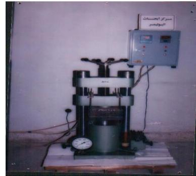
الشكل (1) جهاز المكبس الهيدرووليكي
