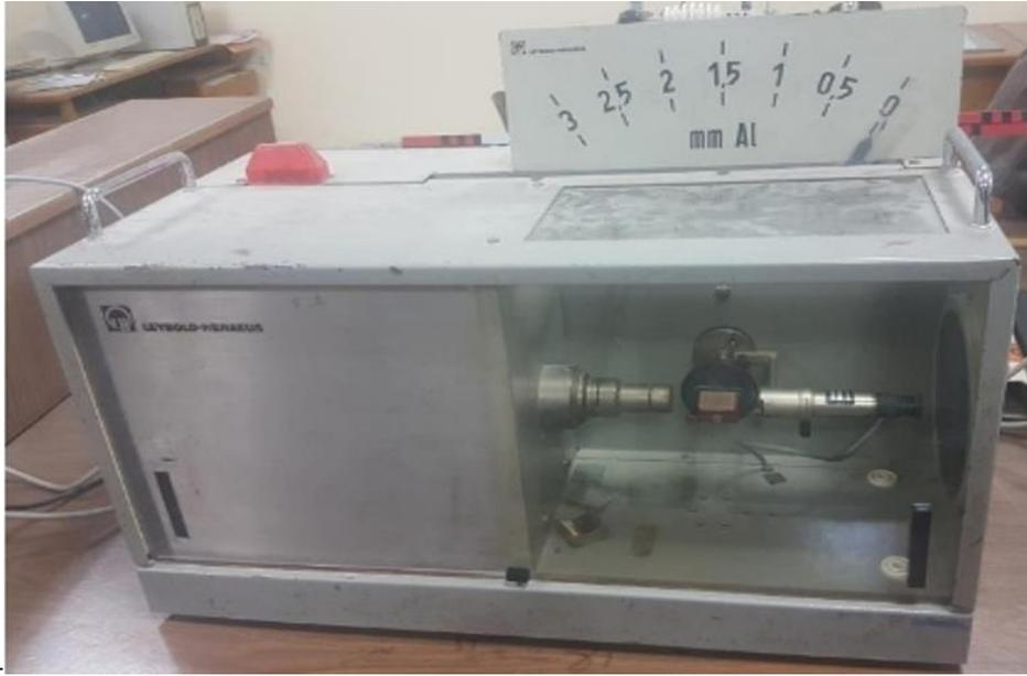
الشكل رقم (2) صورة فوتوغرافية لجهاز مولد الأشعة السينية نوع (LEYBOLD-HERAEUS)
