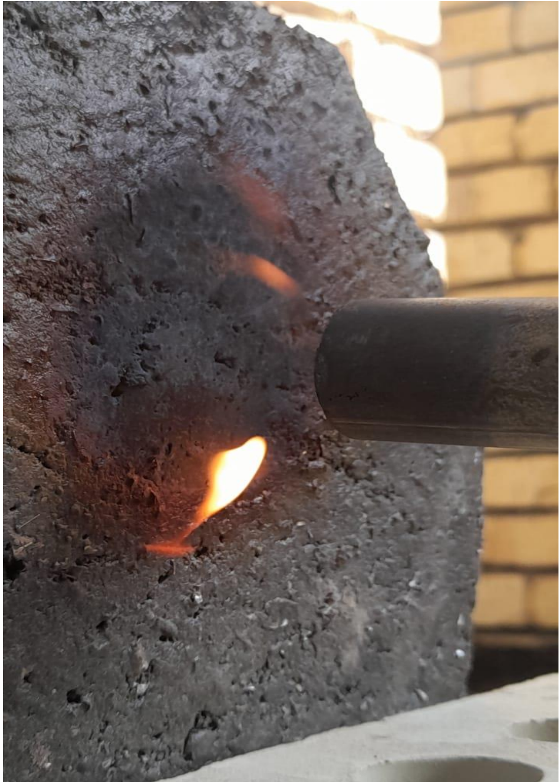
الشكل (16) عملية الحرق للوح المحضر.
