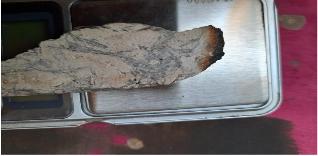
الشكل (10) النموذج المحضر اثناء فحص الاحتراق.
