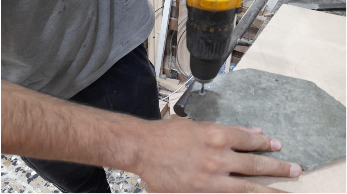
الشكل (15) عملية ثقب اللوح بواسطة أدوات النجارة الكهربائية.
