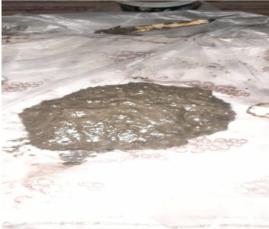
الشكل (5) العجينة بعد عمليتي الخلط والصب على سطح بلاستيكي.
