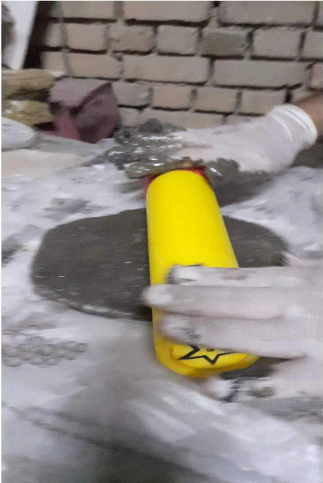
الشكل (8) الوصول الى الشكل النهائي للوح مع استمرار الكبس للوصول الى السمك المطلوب.
