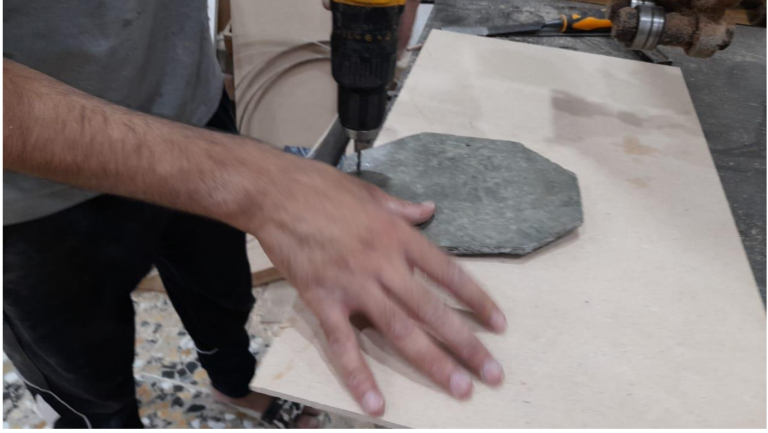
الشكل (14) استخدام أدوات النجارة في تقطيع وثقب الالواح المحضرة.
