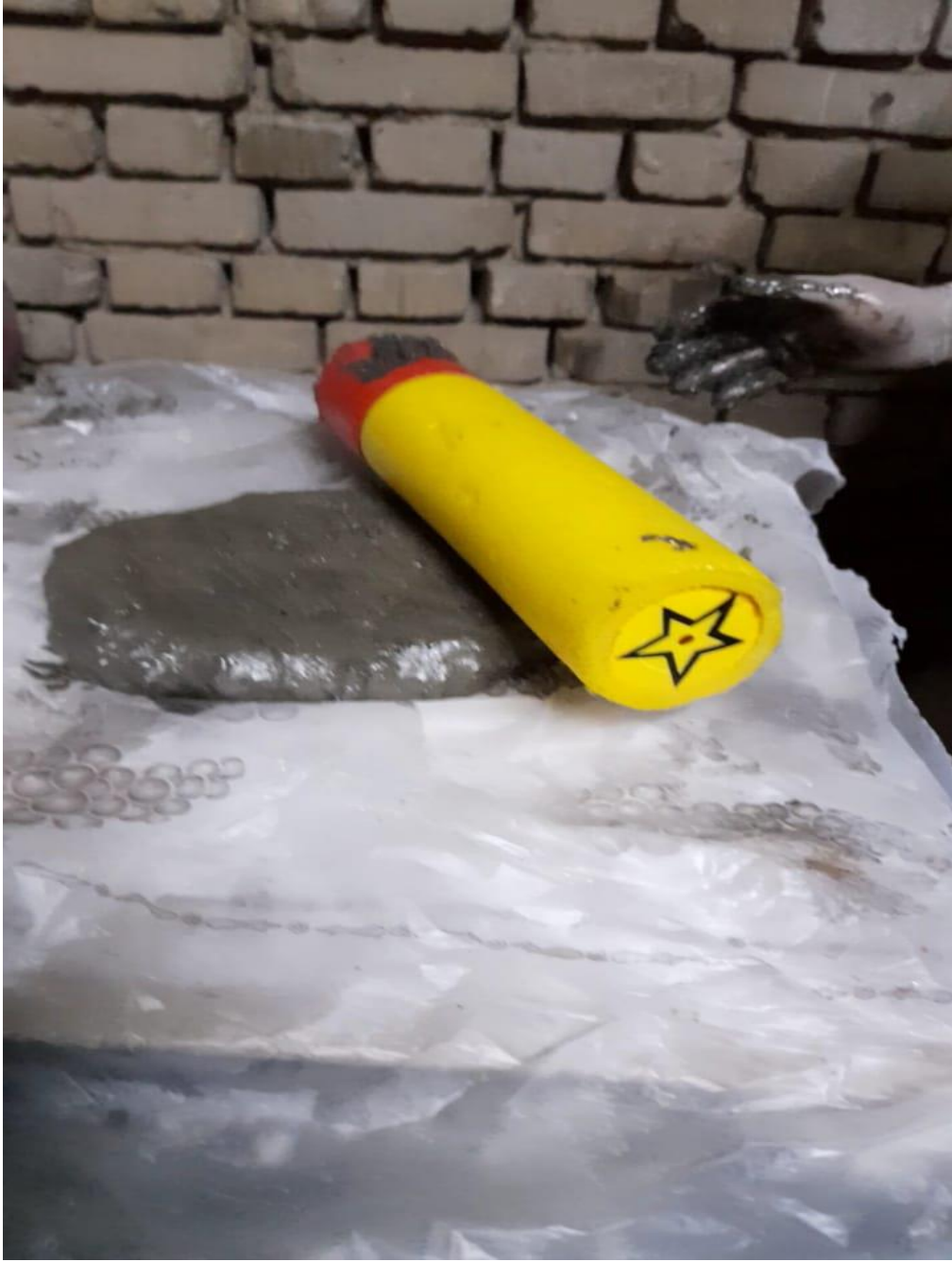
الشكل (6) بداية عملية التسطيح والضغط للعجينة المحضرة.
