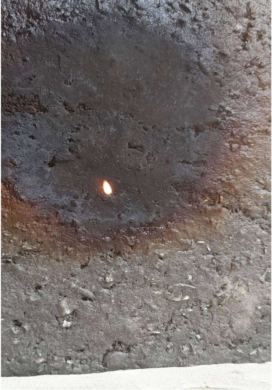
الشكل (17) الانطفاء الذاتي للالواح المحضرة حتى بعد خمس دقائق من التعرض المستمر الى اللهب.
