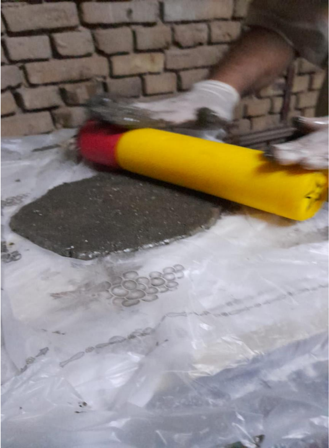
الشكل (7) العجينة أثناء عملية الضغط لغرض تصنيع الألواح.
