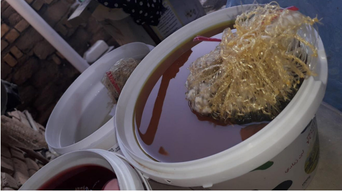
الشكل (9) أمتصاص العينة لزيت المحرك
