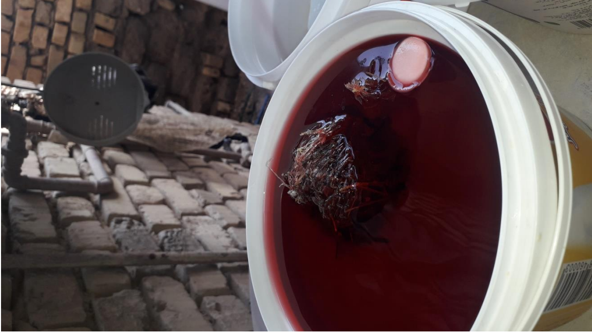
الشكل (8) العينة المغمورة في زيت الهيدروليك
