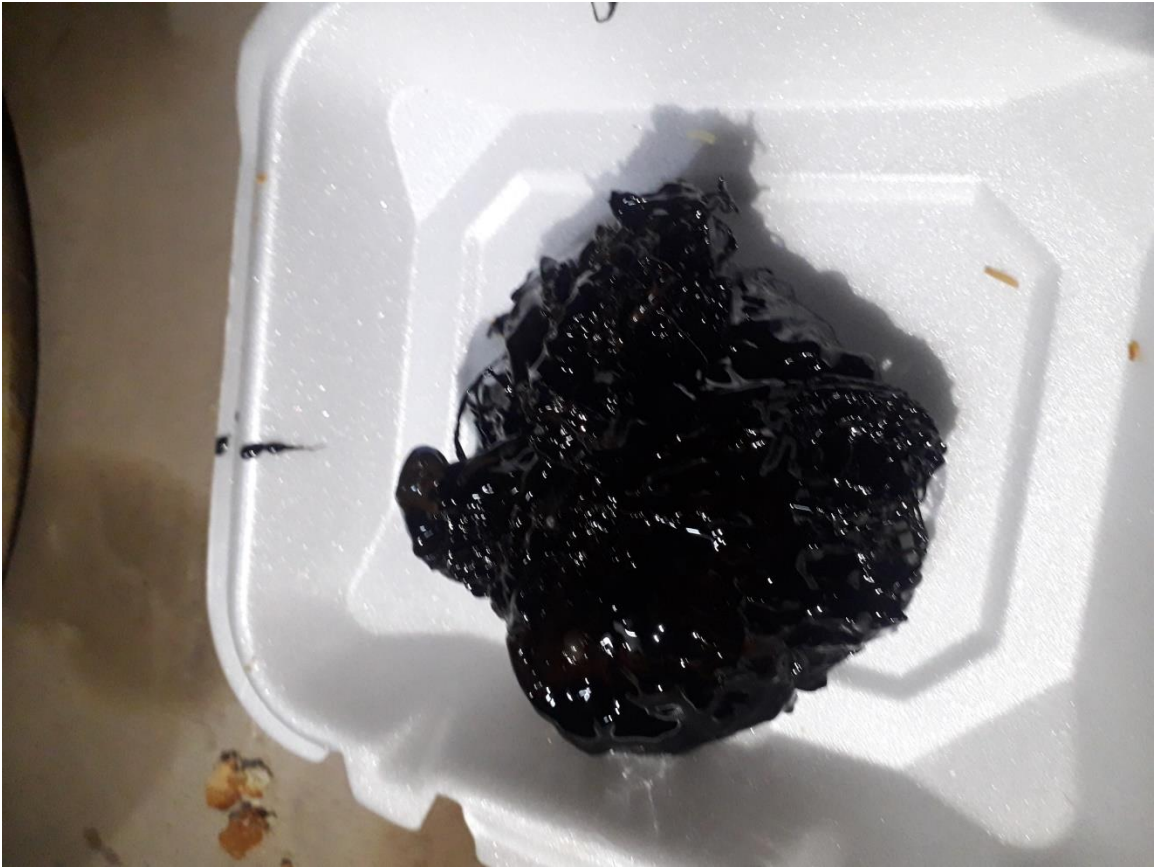
الشكل (13) العينة بعد مرور سنة كاملة من الغمر في النفط الخام
