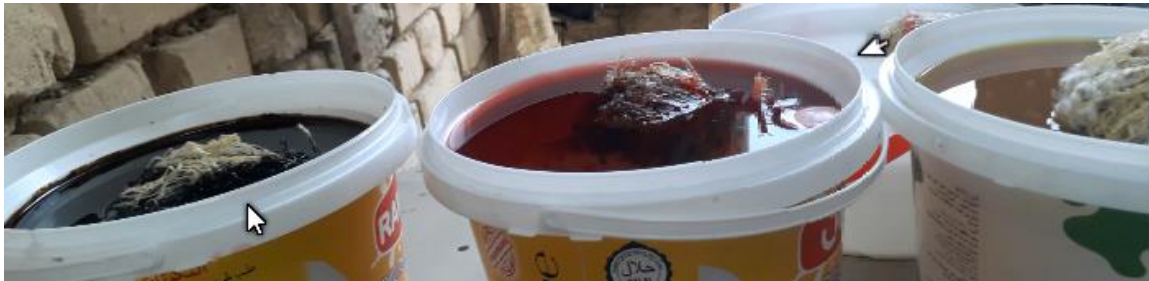
الشكل (5) النماذج المغمورة في النفط الخام _ زينب المحرك - زيت الهيدروليك - الماء
