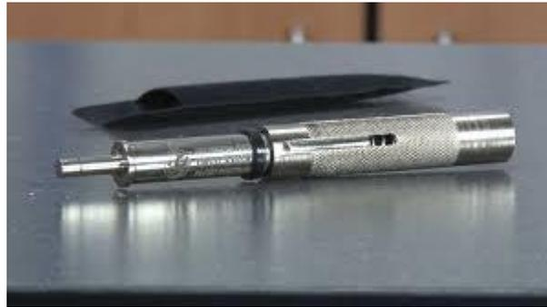
(جهاز قياس مقاومة التربة للاختراق المختبرية)
