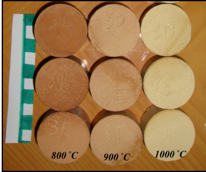
شكل 2: استقامة الحافات وتدرج ألوان النماذج المصنعة مع درجات حرارة الحرق المختلفة
