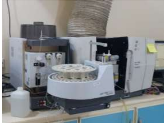
صورة (1): جهاز مطياف الامتصاص الذري الذي اجري بواسطته فحص عينات الدراسة
