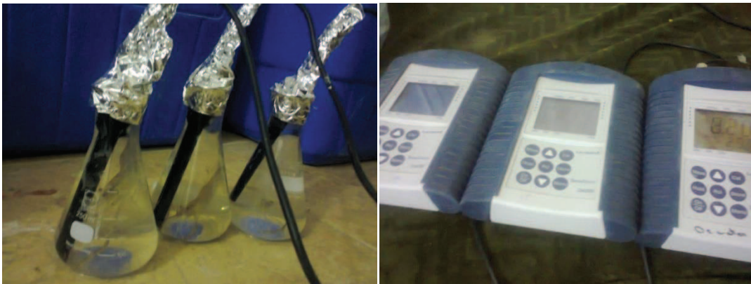
صورة (7): الأجهزة وأقطابها المستعملة في قياس الأوكسجين ليافعات الروبيان الشرقي M. nipponense .
